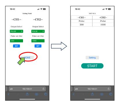
⑦ Setting 画面で設定した値を確認し、問題なければ START ボタンを押すと 各 CH の BNC コネクタから出力します。 信号の出力はボックスの上部についている START スイッチでも出力開始します。 START スイッチを再度押すと、出力は停止となります。
